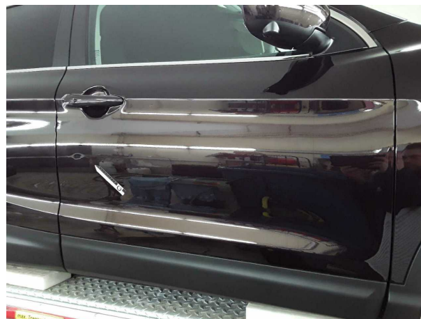
Beschädigung #4: Tür vorn rechts: Tür (3) - Delle(n)
