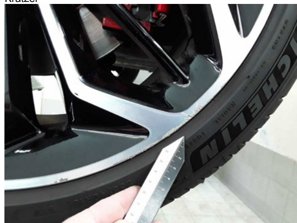
Beschädigung #3: Rad/Reifen: Leichtmetallfelge vorn rechts - Kratzer
