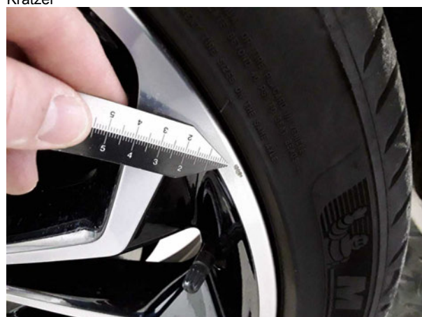
Beschädigung #2: Rad/Reifen: Leichtmetallfelge vorn links - Kratzer
