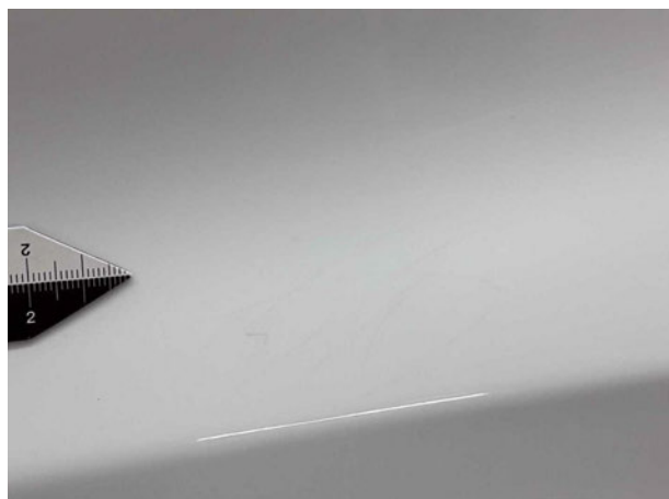
Beschädigung #4: Tür hinten links: Tür - Kratzer
