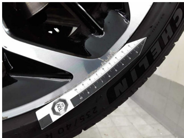
Beschädigung #3: Rad/Reifen: Leichtmetallfelge vorn rechts - Kratzer
