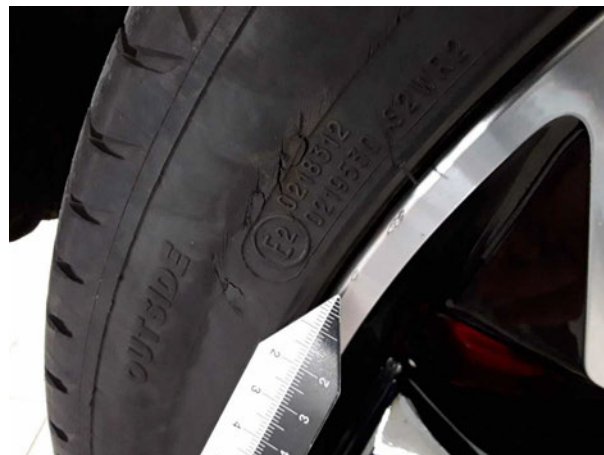
Beschädigung #1: Rad/Reifen: Leichtmetallfelge hinten rechts - Kratzer
