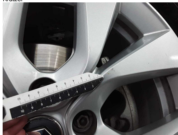
Beschädigung #4: Rad/Reifen: Leichtmetallfelge vorn rechts - Kratzer
