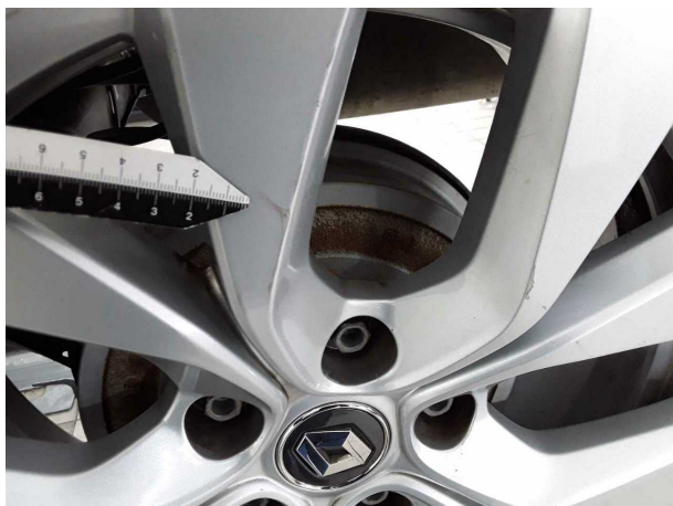
Beschädigung #3: Rad/Reifen: Leichtmetallfelge hinten links - Kratzer
