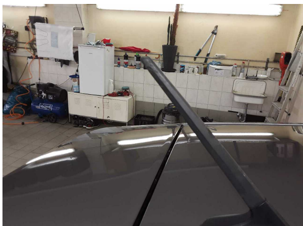
Beschädigung #2: Fahrzeugdach: Antennenstab - Marderschaden
