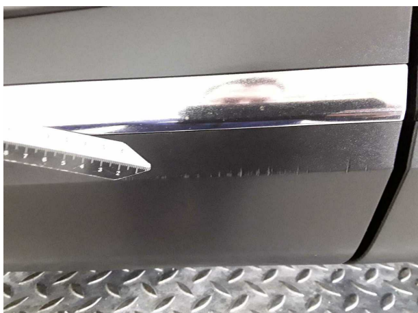
Beschädigung #10: Tür vorn links: Zierleiste unten - Kratzer
