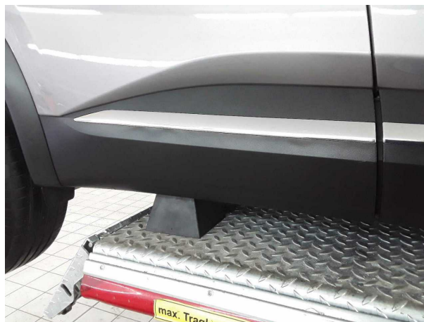
Beschädigung #9: Tür hinten rechts: Zierleiste unten - Kratzer
