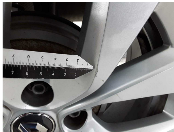
Beschädigung #3: Rad/Reifen: Leichtmetallfelge hinten links - Kratzer
