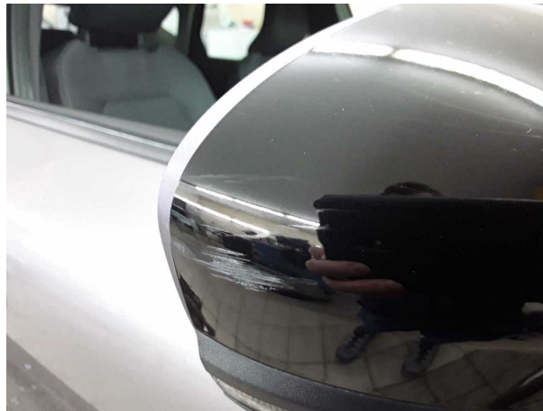
Beschädigung #1: Außenspiegel rechts: Abdeckkappe - Kratzer
