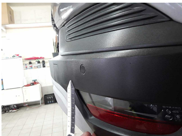
Beschädigung #8: Stossfänger hinten: Spoiler - verformt
