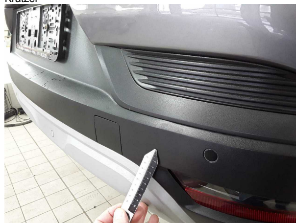
Beschädigung #8: Stossfänger hinten: Spoiler - verformt
