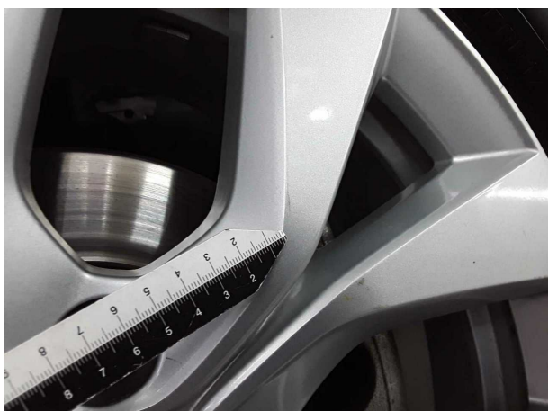
Beschädigung #4: Rad/Reifen: Leichtmetallfelge vorn rechts - Kratzer
