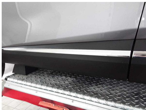
Beschädigung #10: Tür vorn links: Zierleiste unten - Kratzer
