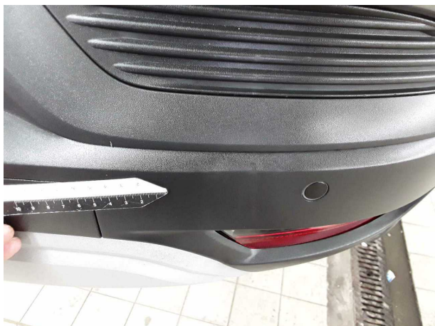
Beschädigung #8: Stossfänger hinten: Spoiler - verformt
