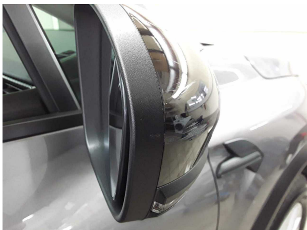
Beschädigung #1: Außenspiegel rechts: Abdeckkappe - Kratzer
