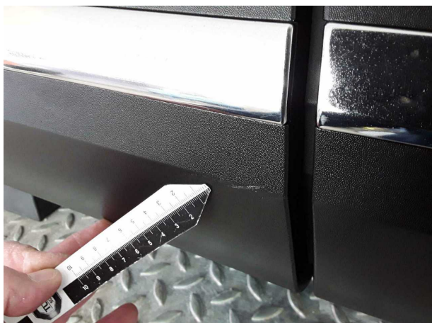
Beschädigung #9: Tür hinten rechts: Zierleiste unten - Kratzer
