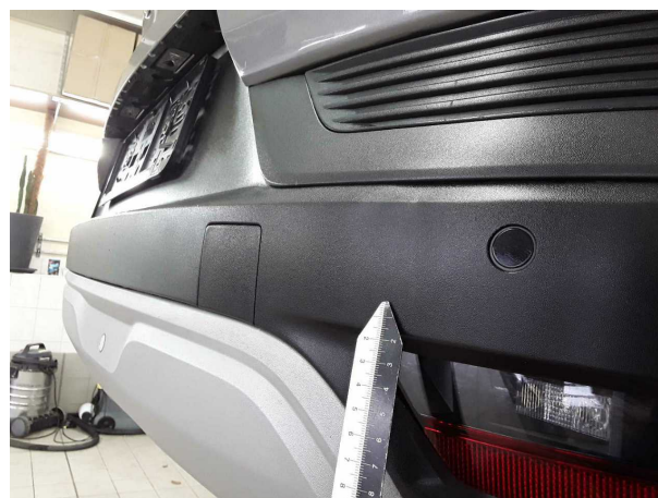
Beschädigung #8: Stossfänger hinten: Spoiler - verformt
