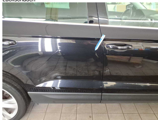
Beschädigung #10: Tür hinten rechts: Tür (Kratzer) - Delle / Lackschaden
