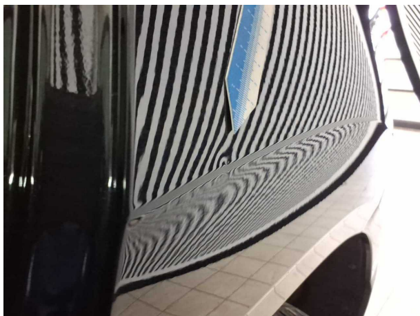
Beschädigung #6: Seitenwand links: Seitenwand - Delle(n)
