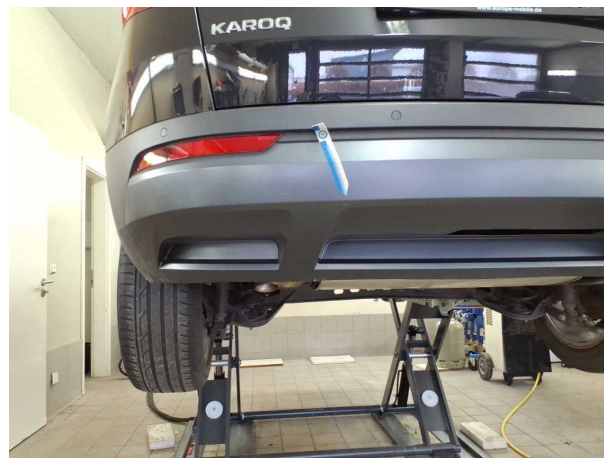
Beschädigung #8: Stossfänger hinten: Stossfänger hinten (Unterteil) - Kratzer
