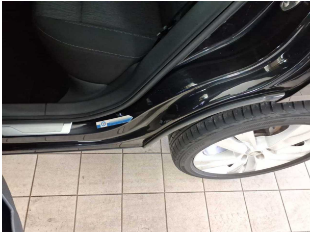
Beschädigung #4: Seitenwand links: Einstieg (Kratzer) - Delle(n)
