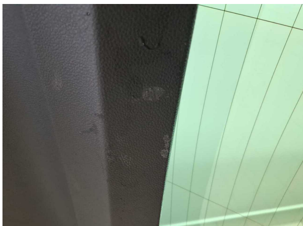
Beschädigung #2: Heckklappe/-tür: Verkleidung Standard unten - verkratzt / verschürft
