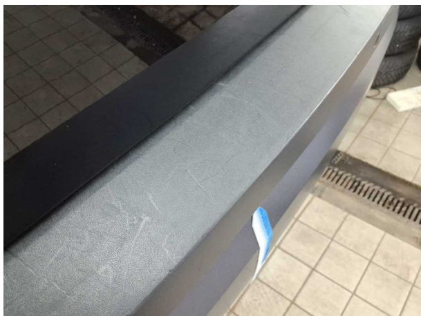
Beschädigung #9: Stossfänger hinten: Stossfänger hinten - verkratzt / verschürft
