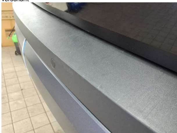
Beschädigung #9: Stossfänger hinten: Stossfänger hinten - verkratzt / verschürft
