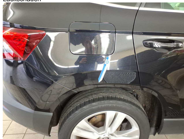
Beschädigung #7: Seitenwand rechts: Seitenwand - Delle / Lackschaden
