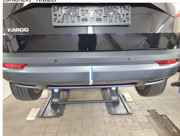
Beschädigung #9: Stossfänger hinten: Stossfänger hinten - verkratzt / verschürft
