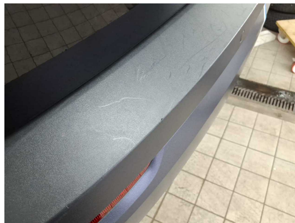
Beschädigung #9: Stossfänger hinten: Stossfänger hinten - verkratzt / verschürft
