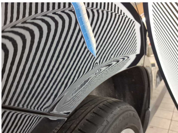
Beschädigung #7: Seitenwand rechts: Seitenwand - Delle / Lackschaden
