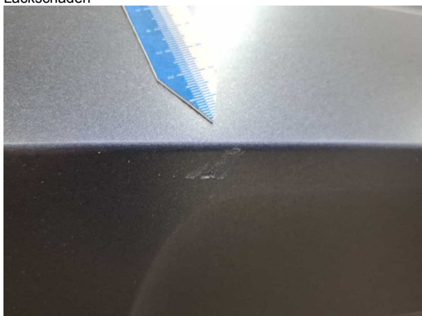
Beschädigung #8: Stossfänger hinten: Stossfänger hinten (Unterteil) - Kratzer
